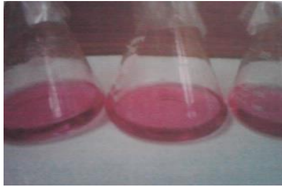
Gambar 3. Larutan sampel 20 ml ditambahkan dapar 3 ml kemudian tambahkan indikator murexside 50 mg
