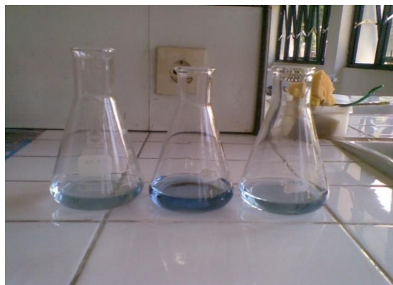
Gambar 2. Larutan dititrasi dengan Na_2EDTA sampai terjadi perubahan warna dari merah anggur menjadi biru.
