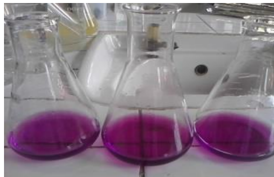
Gambar 4. Larutan dititrasi dengan \text{Na}_2\text{EDTA} sampai terjadi perubahan warna dari merah muda menjadi ungu.
