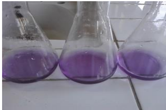
Gambar 1. 25 ml larutan ZnSO_4 ditambahkan dengan 3 ml dapar kemudian tambahkan 50 mg indikator EBT
