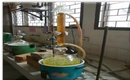
Gambar 2. Alat Refluks ( Rumput Gajah Menggunakan Alat Refluks)
